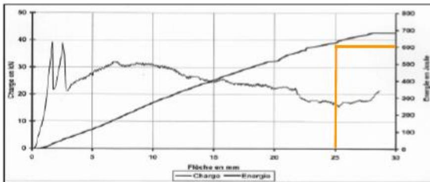
Curva di rottura/spostamento – Energia/spostamento CHRYSO®Fibre S50 a 4 kg/m<sup>3</sup>
